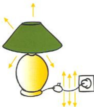
La lampe est branchée mais éteinte, il y a un champ électrique mais pas de champ magnétique
