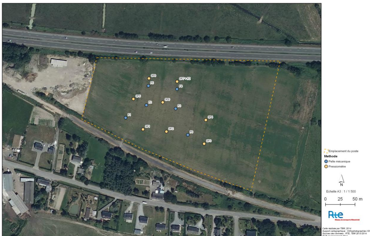
Figure 147 : localisation des sondages géotechniques
